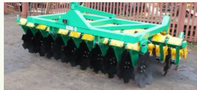
Фото. 2 Агрегат почвообрабатывающий навесной АПН-3-01 Photo. 2 Soil-cultivating unites hinged APN-3-01
