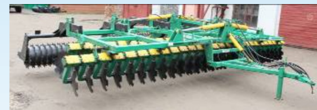
Фото3. Агрегат почвообрабатывающий АПД-7,5М-1 Photo 3. Soil-cultivating disk machine APD-7.5M-1
