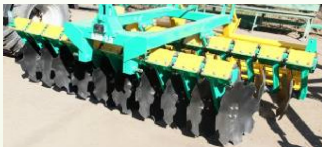
Фото. 1 Агрегат почвообрабатывающий навесной АПН-2,5 Photo. 1 Soil-cultivating unites hinged APN-2.5
