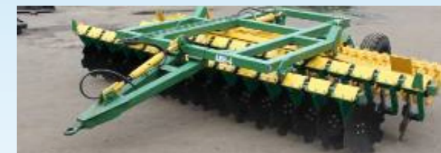
Фото. 4 Агрегат почвообрабатывающий полунавесной АПН-4 Photo. 4 Soil-cultivating unites semi-hinged APN-4
